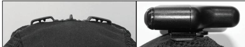
Die PowerBox kann sehr leicht für Beladung entfernt werden oder durch eine voll beladene ersetzt werden. Ziehen Sie die PowerBox von den Schlitzungen nach oben.
