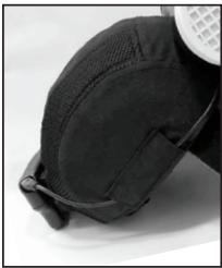
b.1. Snu enheten opp-ned, og sett inn luftstrømsmåleren ved luftutgangen i capsen. Påse at måleren er festet skikkelig, og at det ikke er lekkasje i kantene. Sørg for at filtene er frie for motstand.
