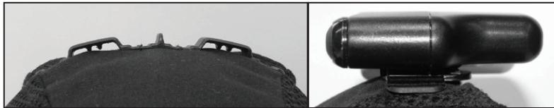
PowerBox batteriet kan enkelt fjernes eller evt. Byttes ut med nytt oppladet batteri ved lengre skift.
