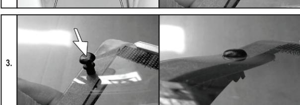
3. Utilizando los nuevos remaches provistos, fije el lado izquierdo de la pantalla a la izquierda de la soporte de la visera. Asegúrese de que el remache haya pasado por ambos lados de la montura.
