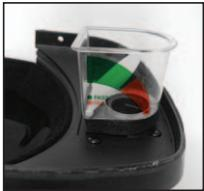
b.3. I tilfellet indikatoren ligger i "rød sone", bør en sjekk at batteriet er montert skikkelig, og evt. lade batteriet opp. Dersom indikatoren fortsatt viser lav luftstrøm, ta kontakt med JSP eller godkjent forhandler av JSP.
