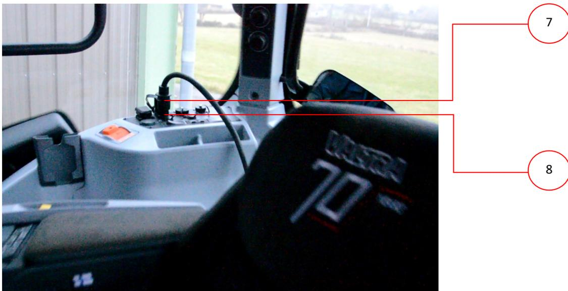
NB : La photo ci-dessus montre que la prise électrique « trois plots » femelle du tracteur agricole est située dans la cabine de ce dernier. Cette photo n'est pas exhaustive, la localisation de la prise peut être différente suivant le modèle et la marque du tracteur agricole.
